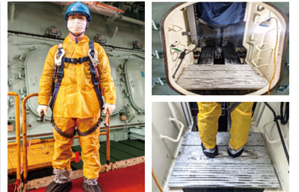
챔버 내 떨어짐 사고 관련 재발방지 대책 이행 점검 결과표(대형엔진시운전3부-안전보호구 및 발판 활용)
